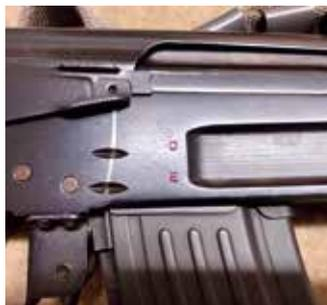
► Gut zu erkennen! Bei der MPi K aus DDR-Fertigung ist die Kennzeichnung am Feuerwahlhebel in Deutsch erfolgt. D steht für Dauer- und E für Einzelfeuer.
