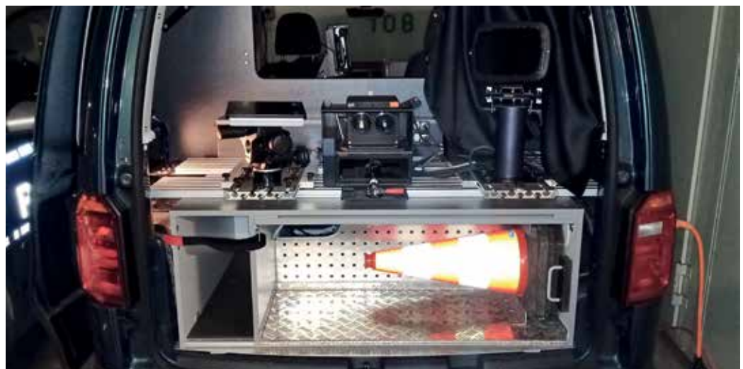
> Das Messsystem Traffistar S350 im Einsatzfahrzeug
